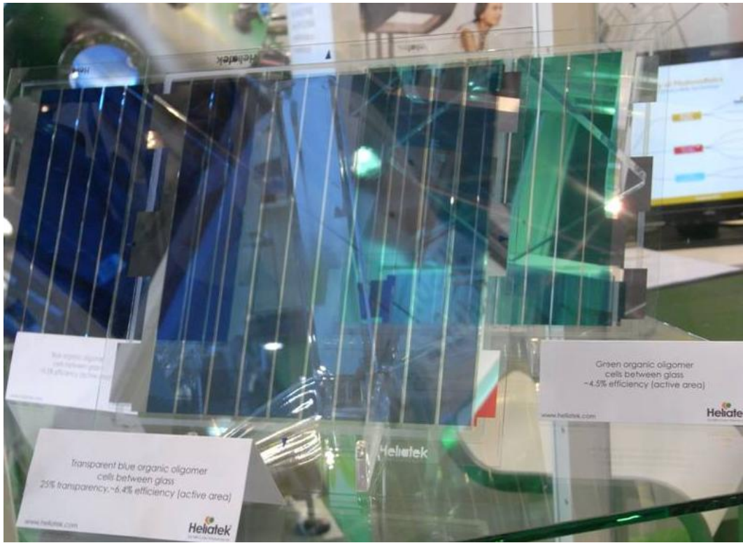
圖 3.96 玻璃基板半透明 OPV
