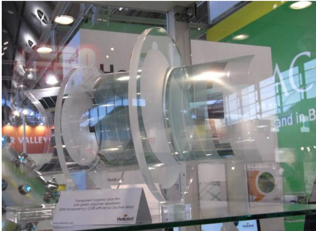
圖 3.98 塑膠基板半透明 OPV
