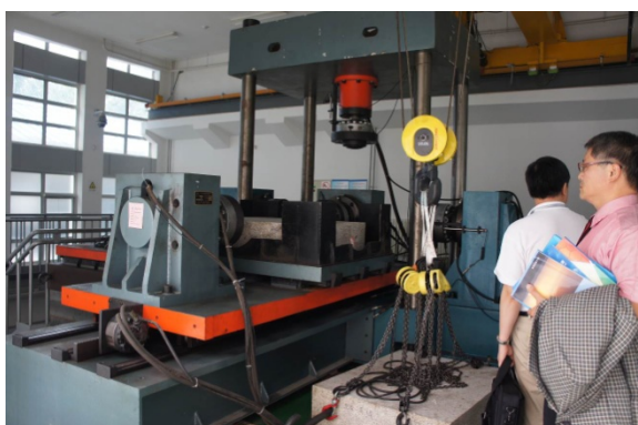
圖 5：花崗岩裂隙水流滲透試驗台
