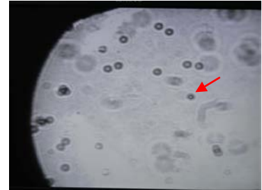
圖八 自製雷射鐳夾系統(在浙江大學展示圖) 圖九 雷射鐳夾捕捉水中微粒子
