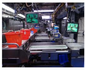
圖 24. Bigelow 試驗船上之漁獲體長體 重量測與條碼掃描設備
