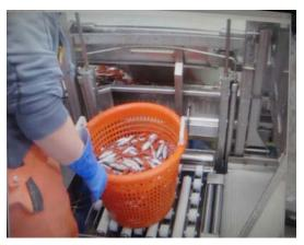
圖 27. 漁獲選別後裝置於有條碼的籃子 送量測體長體重資料
