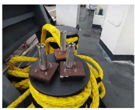
圖 12. 魚探機校正用竿架固定器
