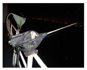
圖 16. 校正竿架安置於船舷基座
