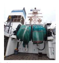
圖 22. Bigelow 試驗船上之拖網網具
