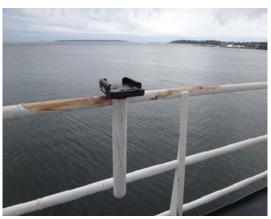
圖 14. 將固定器基座安放於船舷邊之 座槽
