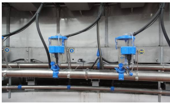
擠乳圓盤台內圈為集乳管線及個別牛隻乳量計紀錄乳量及採樣器採取牛隻乳樣
