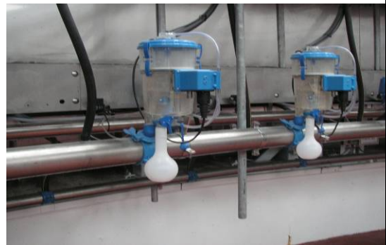
擠乳圓盤台內圈為集乳管線及個別牛隻乳量計紀錄乳量及採樣器採取牛隻乳樣
