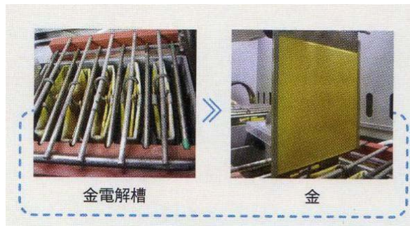
圖七、日鑛公司濕式製程電解槽進行提純
