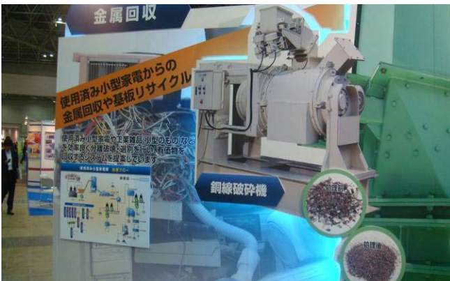
圖十一、展覽會場之電子廢棄物回收方法，包括破碎、分離和集中及靜電展示區
