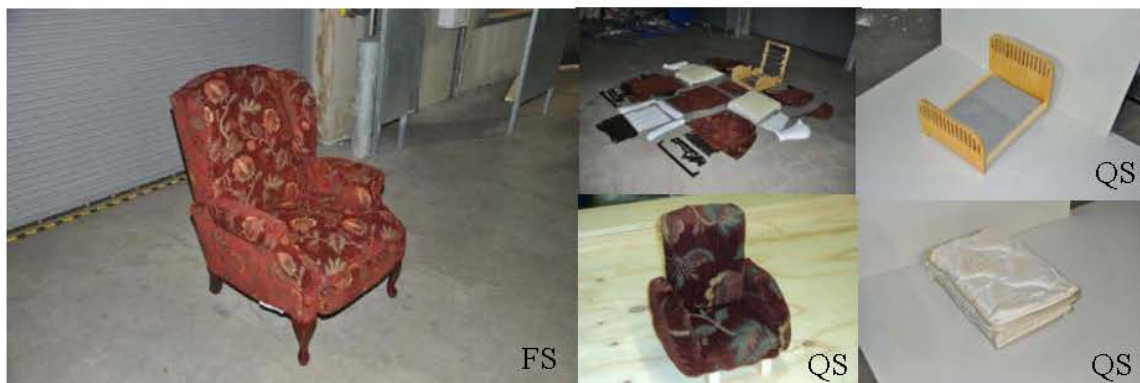
圖9 FS和QS模擬燃燒實驗傢俱縮小之外觀
