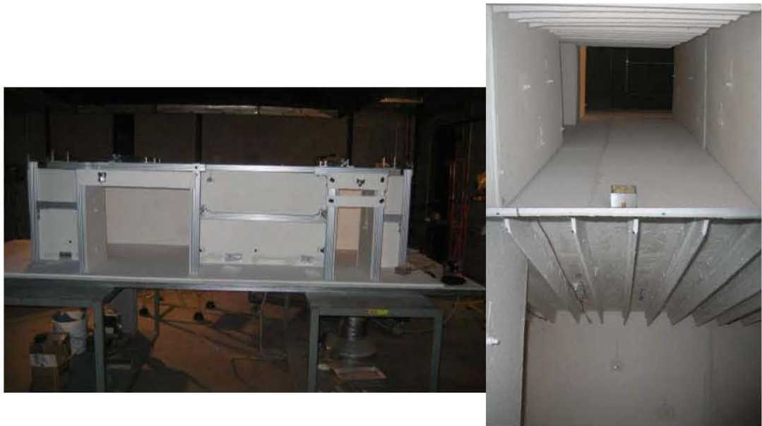
圖4 1/8(高0.56米)縮尺模擬燃燒室
