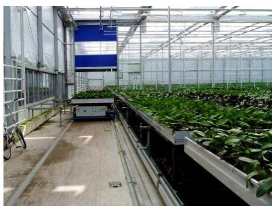
圖 34. 台車式自動化盤床移動系統
