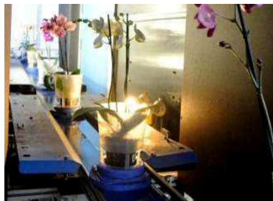
圖 28. 電眼辨識系統進行分級
