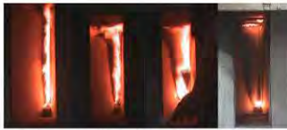
(a)第1分鐘 (b)第10分鐘 (c)第15分20秒崩壞 (d)第20分鐘
