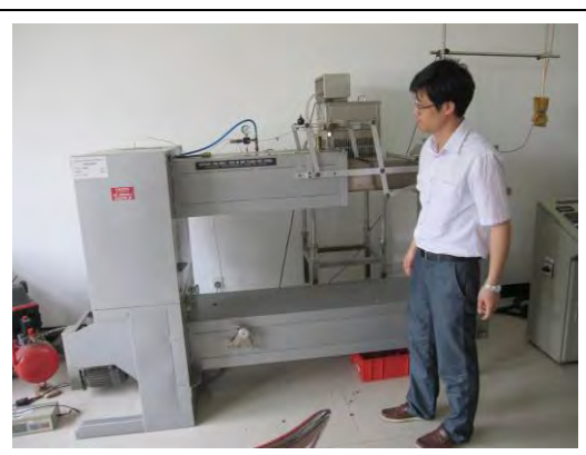
研究員解說灑水頭風洞試驗設備
