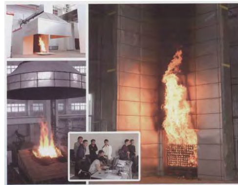
大型量熱儀及外牆保溫材試驗
