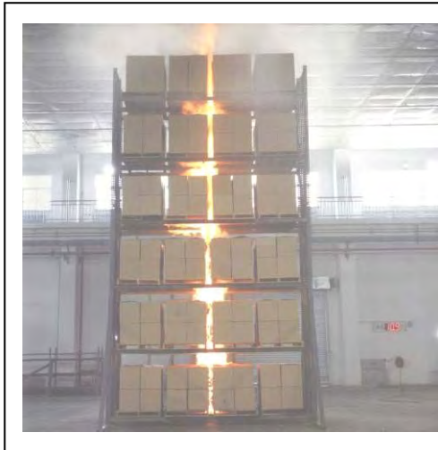
倉儲火災及灑水頭設備滅火模擬
