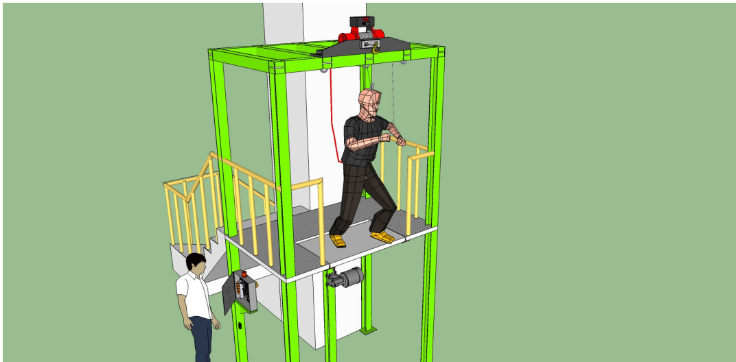
圖 本所人因工程實驗室 墜落模擬平台
