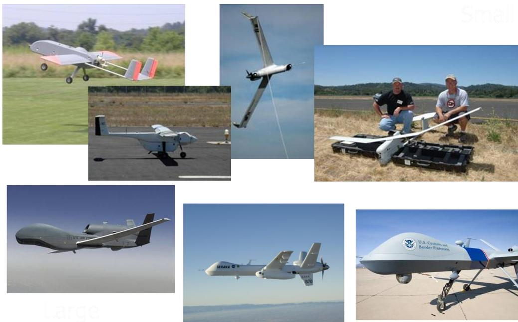
圖16: 林務署應用的無人飛機系統，從酬載5kg以下的小型飛行器到100kg以上的大型飛行器
