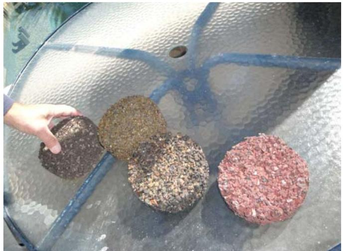
測試再生鋪面材料的滲透率、負荷及透水性等，該等結果對於綠建築的推動及技術均有所助益。
