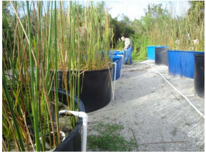
平行的”厭氧-缺氧-有氧(A<sup>2</sup>O)”的處理程序，此程序為廢水處理常用的營養鹽去除程序。靠近植部根部的好氧區是有助於硝化作用進行的，而遠離根部的厭氧區則是脫硝作用發生的區域，二者均扮演將化糞池出流水中殘餘磷淨化的功能。硝酸鹽將在根圈區被脫硝作用有效地去除，而 TN 及 TP 則可藉由定期的植物收割而自系統中移除。Seidel (1955)的研究被公認為是最早使用濕地植栽以自廢水中去除多種污染物的學者，從此有許多研究者就不懈地試圖以各種不同的植栽，以提升廢水中污染物的去除率。
