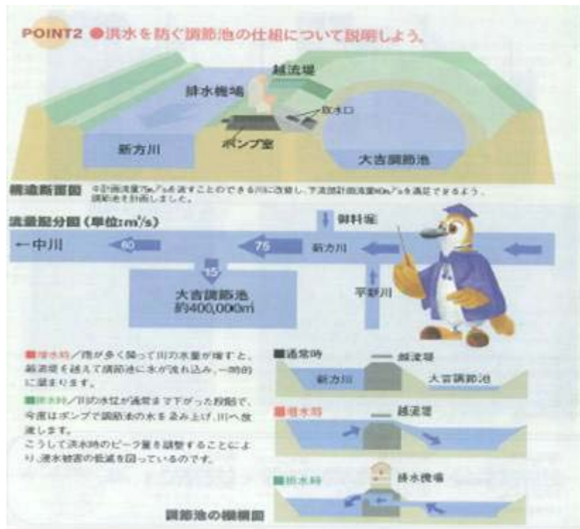
圖-17 調節池及抽水站之操作機制
