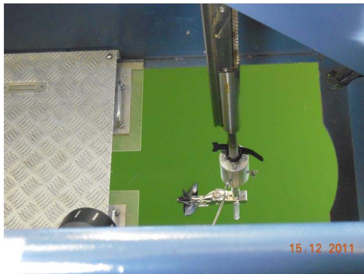
圖-22 速計檢定情形
