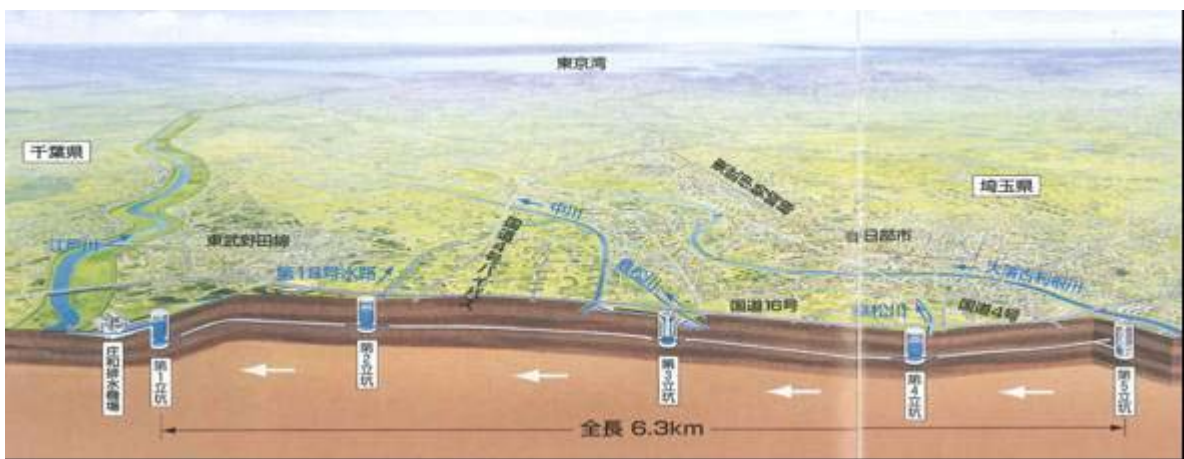
圖-7 東京北郊的埼玉縣地下河川隧道
