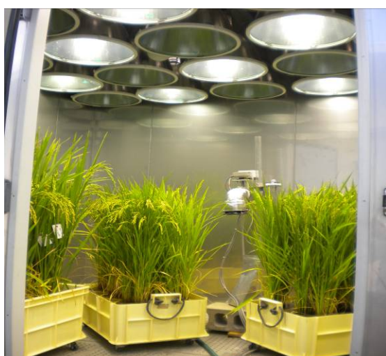
圖 17. 九州沖繩農業研究中心暖地溫暖化研究團隊利用人工氣候室探討高溫對水稻白堊質影響的生理研究
