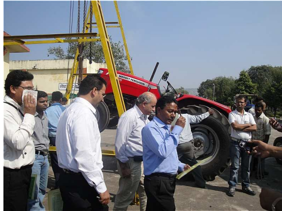
圖 45 曳引機傾斜角及翻覆角測試
