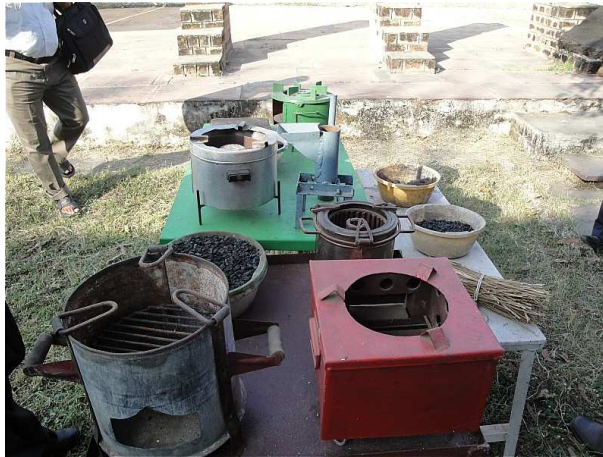
圖 32 各式防熱散逸燃燒爐
