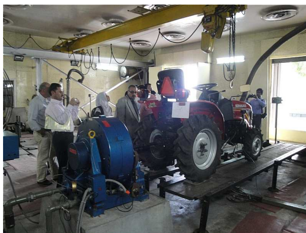
圖 50 動力傳出裝置 PTO 馬力測定
