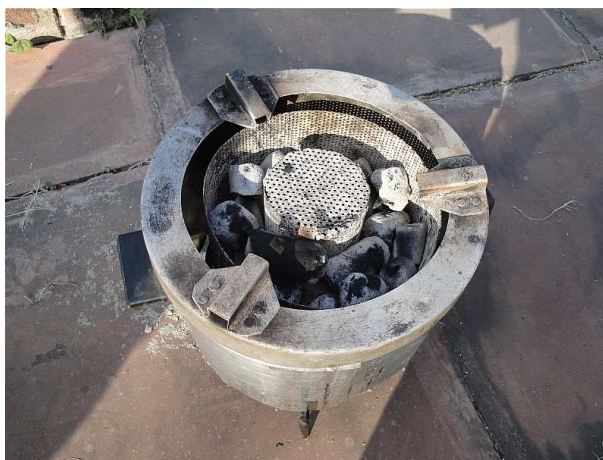
圖 33 防熱散逸燃燒爐燃燒狀況
