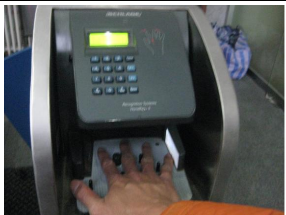
圖十三. 密碼與指紋辨識的出入管制系統
