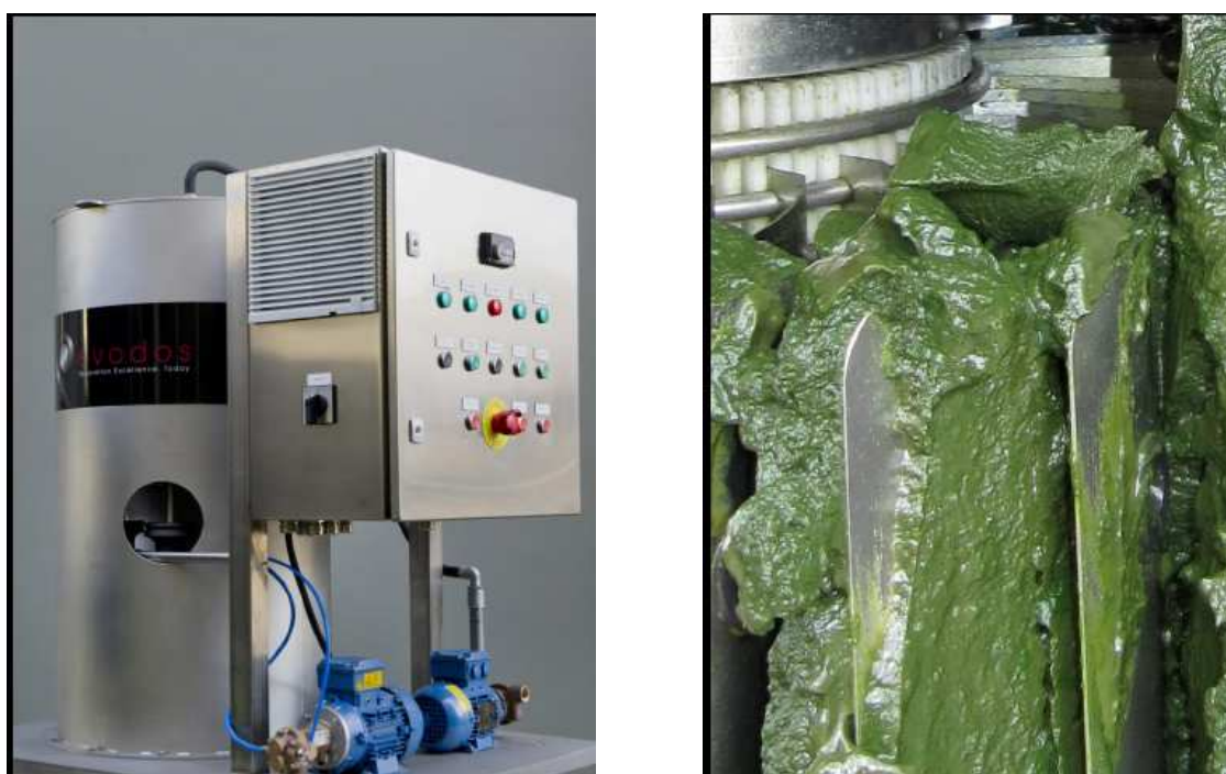
圖10 Evodos spiral plate離心技術
