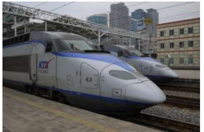
照片52：KTX(韓國高鐵)流線型車頭降低空氣動力音
