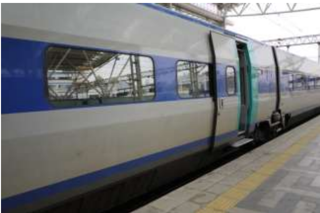
照片53：KTX(韓國高鐵)車廂外型平整降低空氣動力音
