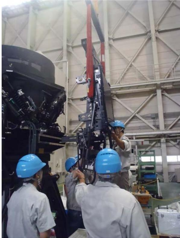
圖 二十四、填隙墊片調整
