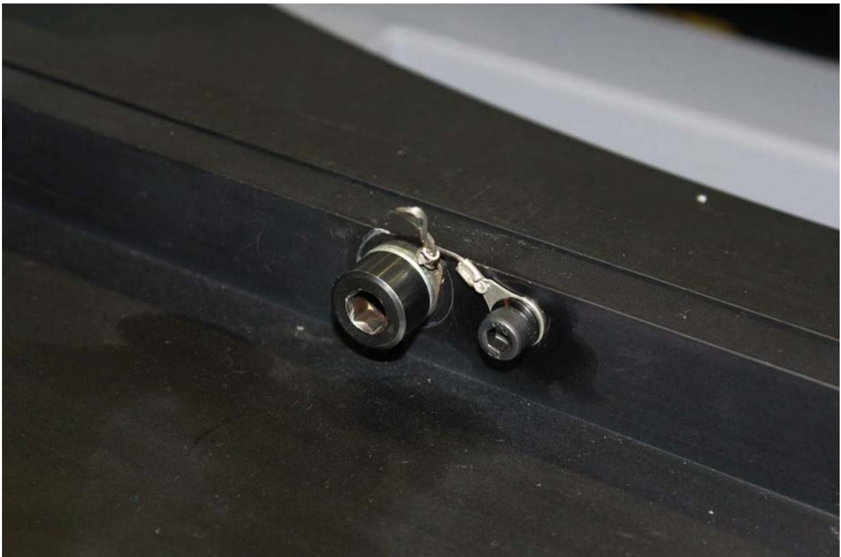
圖 十二、舊界面機匣鎖緊螺栓與防掉落機構
