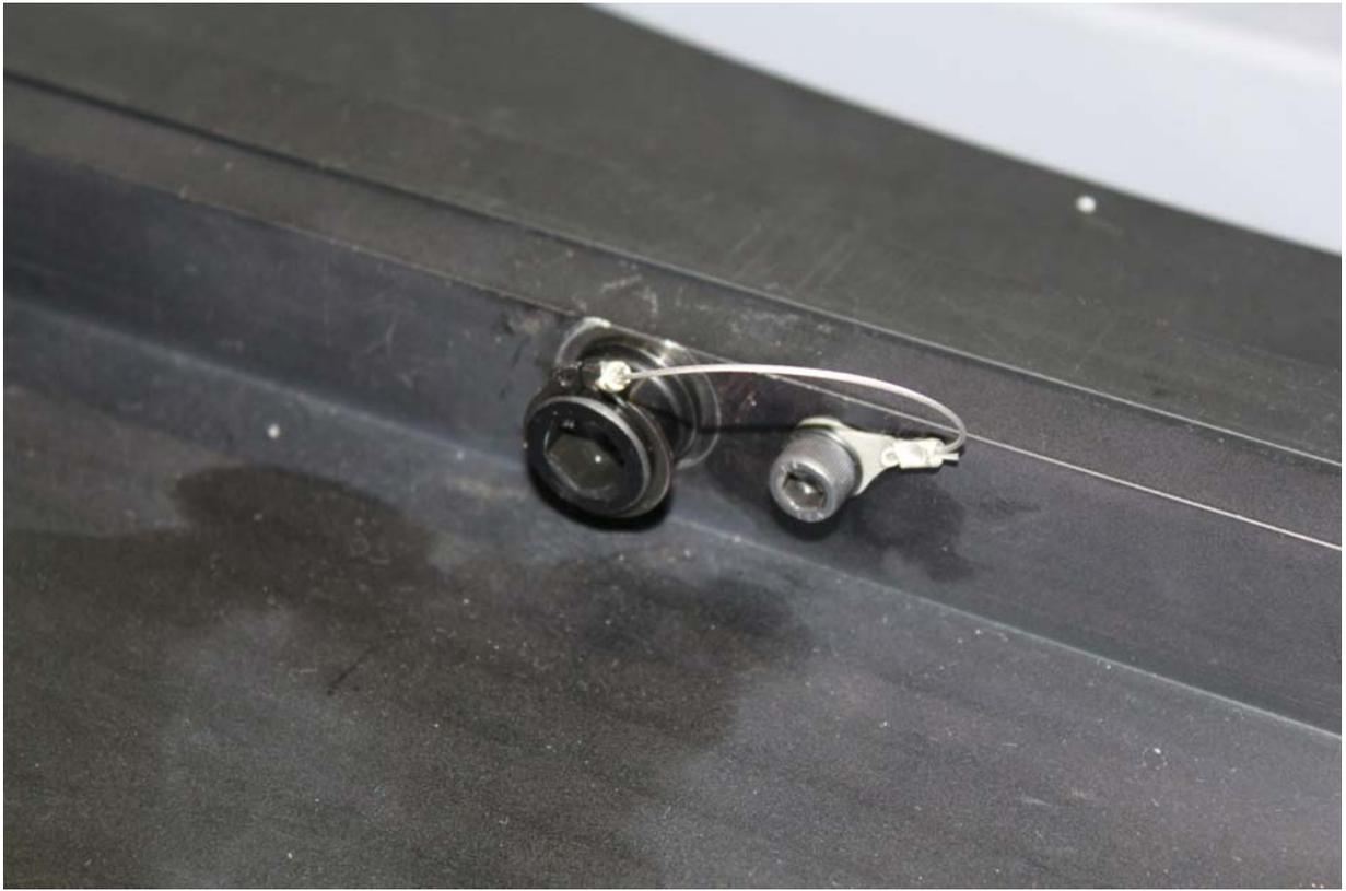
圖 十三、新界面機匣鎖緊螺栓與防掉落機構
