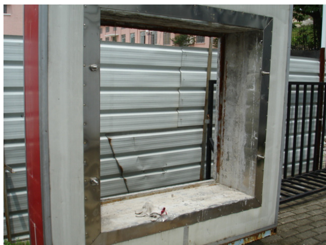
圖 16 窗或牆體隔熱實驗外框架 資料來源：陳伯勳
