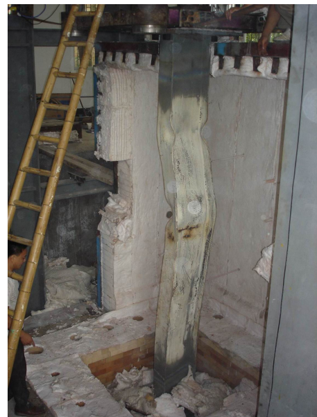
圖 12 結構耐火實驗室鋼柱耐火實驗 資料來源：陳伯勳
