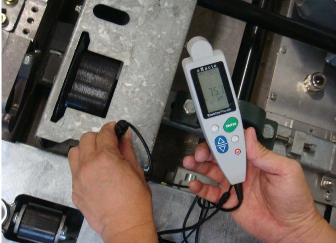
圖 5. 車載行李處理設備之傳送機鍍鋅鋼板厚度量測 (75 \mu m)
