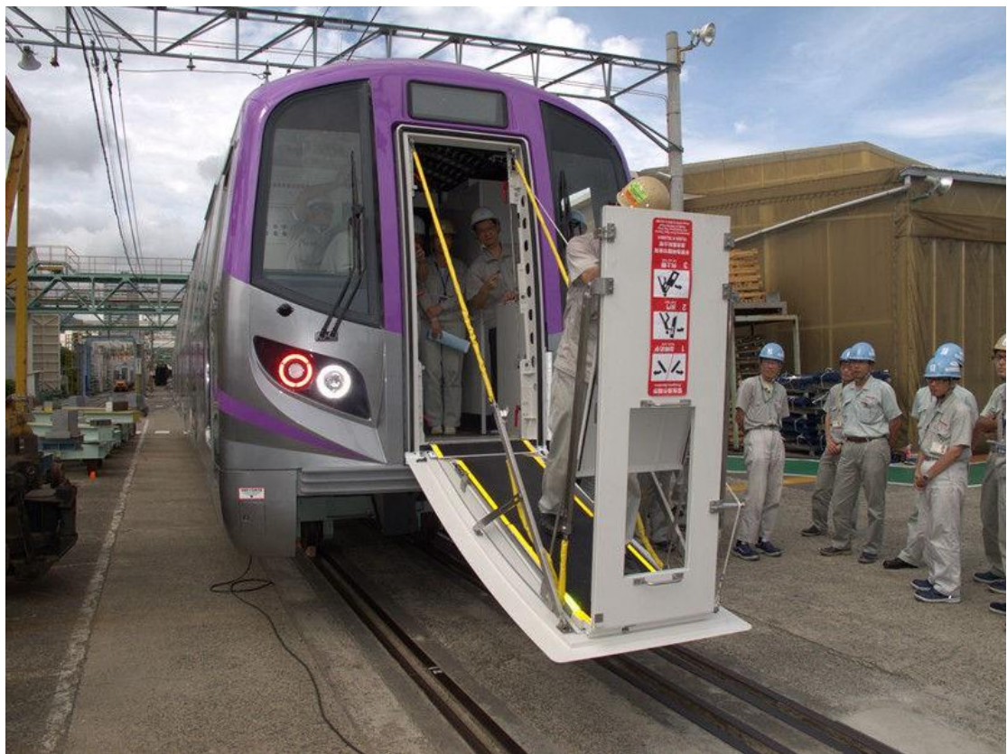
圖 20. 緊急逃生演練 - 開啓駕駛室前端逃生門與逃生坡道
