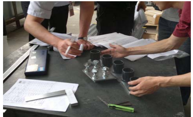
圖 42 扶手驅動組件檢測
