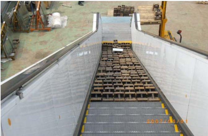
圖 15 以法碼加載於電扶梯踏階上
