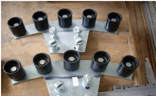
圖 41 扶手驅動組件檢測
