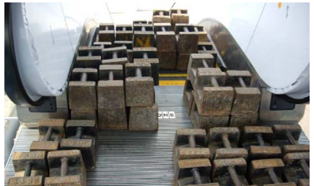
圖 22 確認法碼數量符合計算需求
