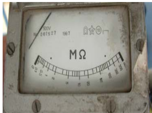
圖 30 控制電路之絕緣測試
