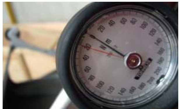
圖 34 梯級螺絲磅數檢測
