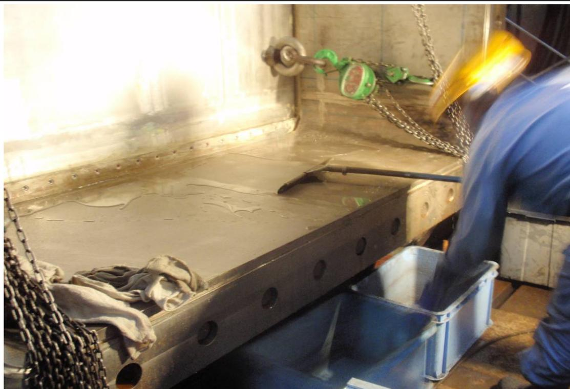
4/23 HPSG 漏水量重新測試—鏈滑車受力情形之漏水實況
