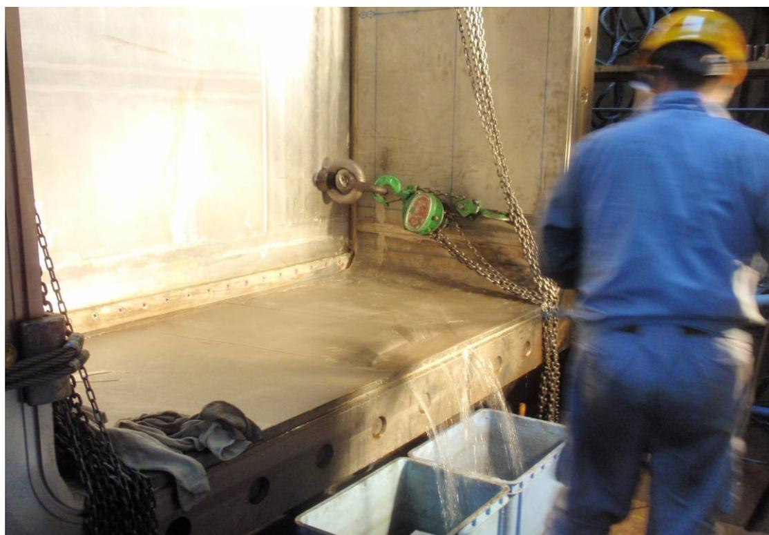
4/23 HPSG 漏水量重新測試—鏈滑車不受力情形之漏水實況
