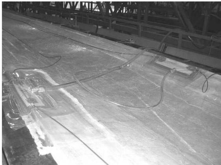
圖 16：在實體葉片上安裝 FIBRADAPT 感測器的測試
