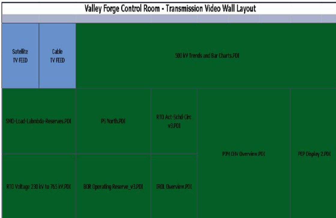
圖 3.10 PJM 電網調度電視牆資訊配置圖
