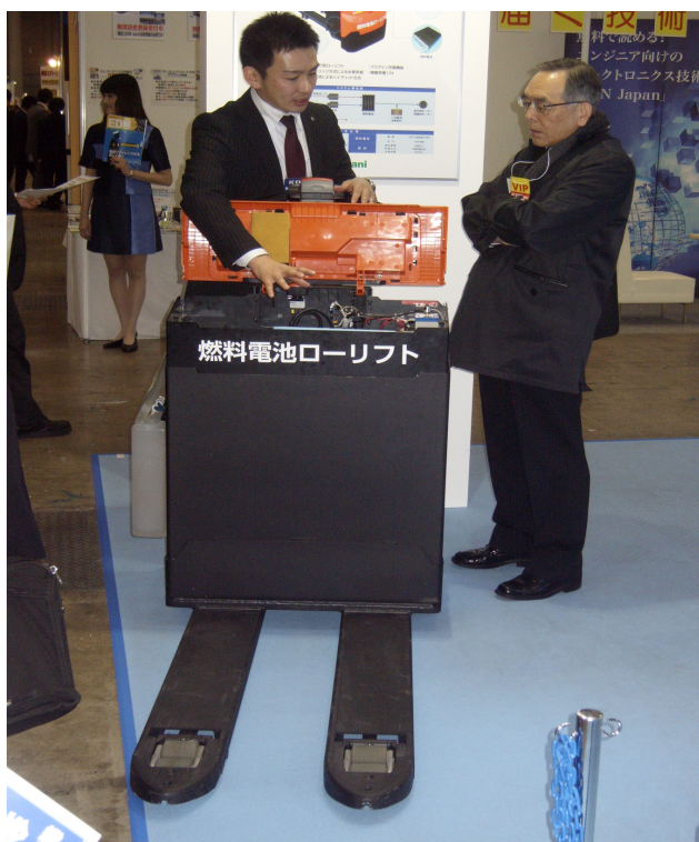
圖 20 Iwatani 展示之氫能燃料電池油壓拖板車
