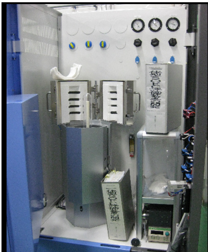
圖 3 CHINO 公司 SOFC 燃料電池測試設備之外觀照
