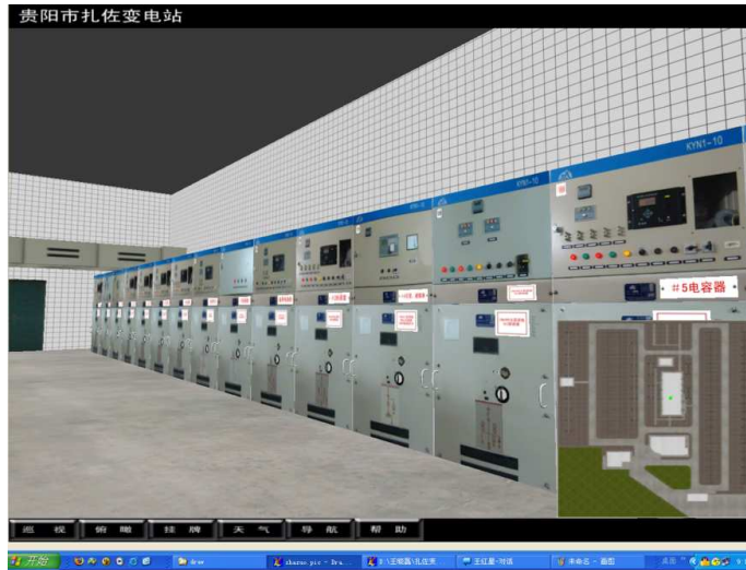
圖 13，培訓仿真系統中有關開關廠的模擬操作圖
