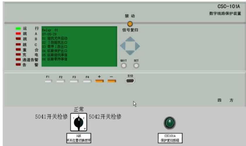
圖 11，培訓仿真系統中有關電驛的模擬操作圖
