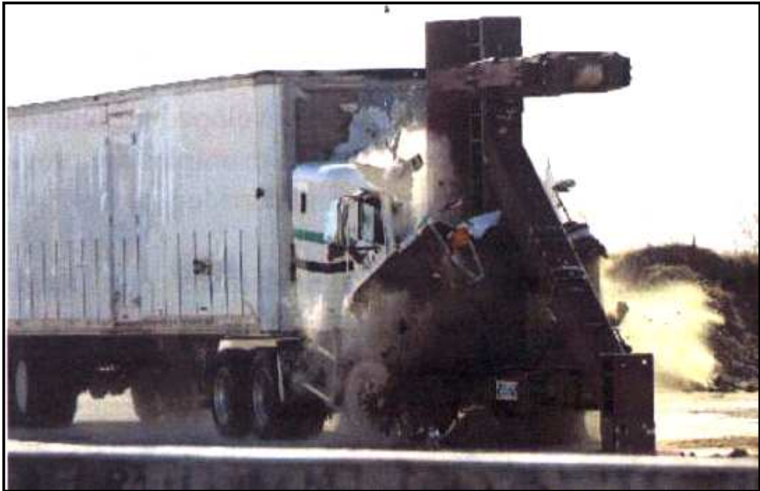
圖 31、以 8 萬磅卡車撞擊橋墩之撞擊實驗
