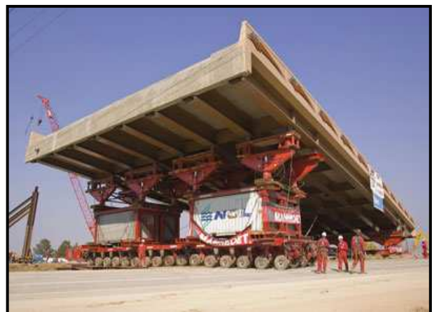
圖 4、自走式模塊車(SPMT 具有 256 個可由電腦獨立操控的輪胎，並具有可昇降 60cm 之液壓系統，主要功能為運送大型物件)
