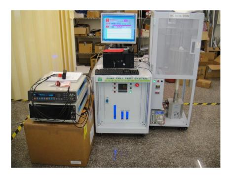
圖 1. CHINO Bottom cell 的測試平台
