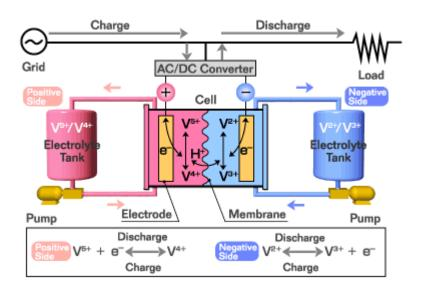
圖7 釩電池的工作原理
