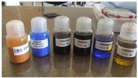
圖 11 VANASAVER12wh 的小型 Demo 系統(上)及電解液色澤變化(下)
