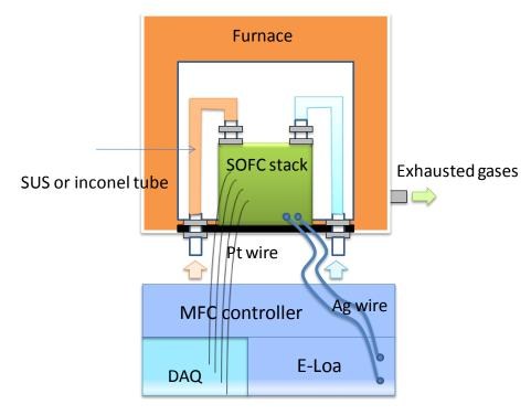
圖 3. SOFC STACK 基本的量平台架構
