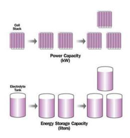
圖 8 VRB 儲電系統功率與儲電容量提昇示意圖
