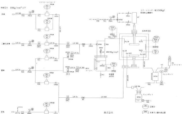
圖 6 CHINO 1KW SOFC 量測平台的設計
