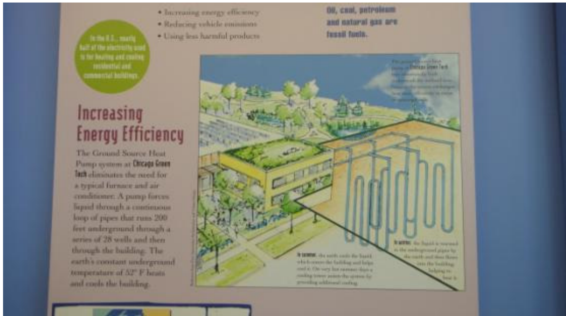
使用 28 個 200 英尺深的地熱系統
