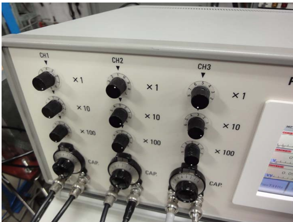
圖 4、石墨卡計模組化系統，包括調整 core(CH1)、jacket(CH2)及 shield(CH3)部份
