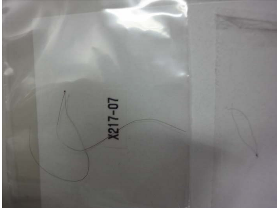
圖 5、日本 AIST 石墨卡計採用的熱敏溫度計(NTC THERMISTORS)
