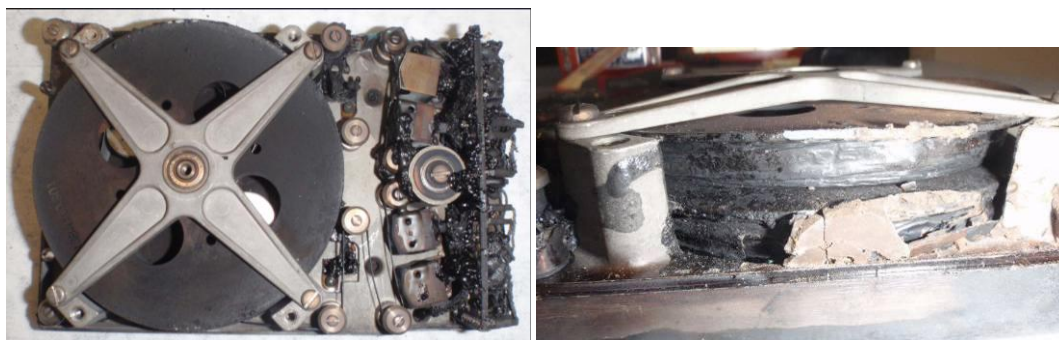
圖 3.1-1 PV1584 FDR 損壞情形
