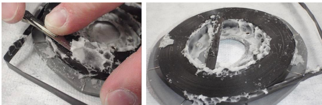
圖 3.1-4 以手工剝除法移除包覆 CVR 之融化塑膠
