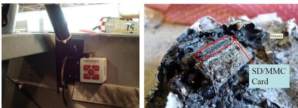
圖 3.2-8 GAU1000 型紀錄器，左圖為正常裝置，右圖為事故燒毀裝置
