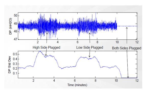
圖-9 差壓傳送器導壓管阻塞
