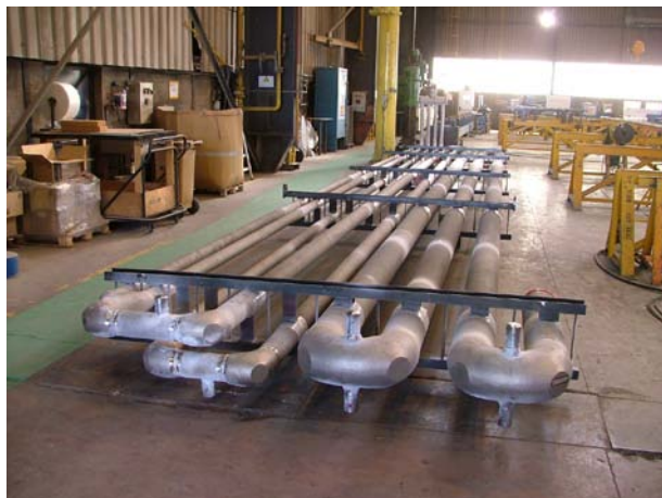
圖 14 爐管檢驗完成
