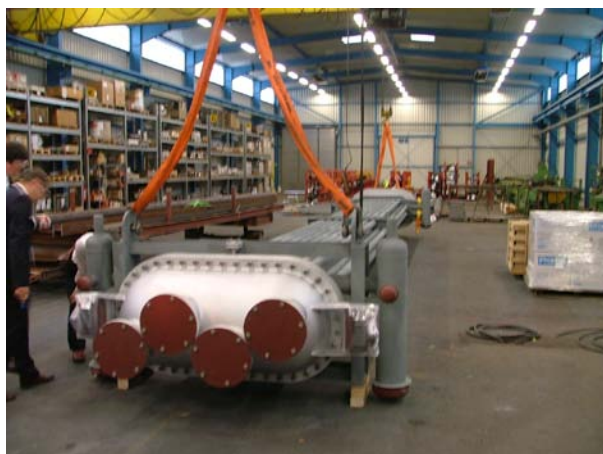
圖 3 TLE 製作完成準備試壓
