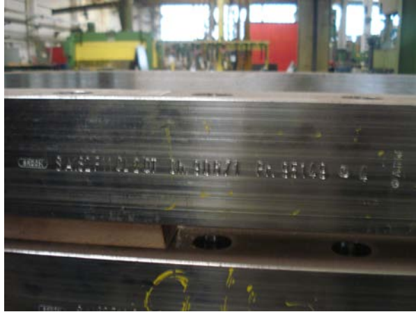
圖 5 PMI 材料確認程序完成
