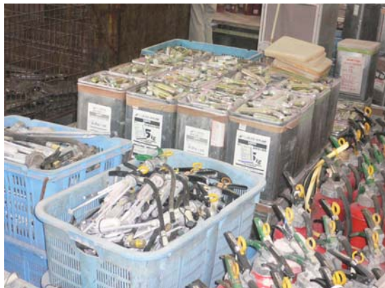
拆解後之金屬構件(管件等)
