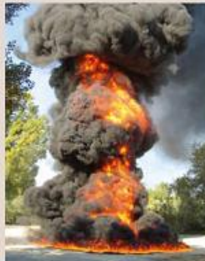
小型模型タンクを使ったボイルオーバーの実験 Boil-over experiment in a small model tank
