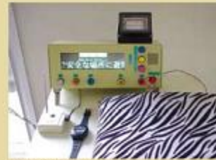
聴覚に障害のある方のための火災警報通報装置 Fire alarm notification system for the hearing impaired
