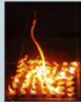
「火災旋風」の実験。水平方向に風速が変化する横風中におかれた複数の火炎から火災旋風が発生している。 Fire whirl experiment. A fire whirl results from multiple flames in a crosswind in which the wind changes in a horizontal direction.
