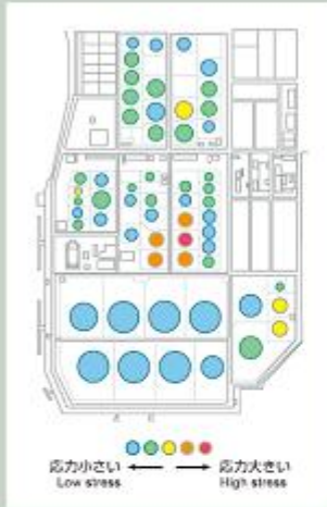
強震動予測結果にもとづいて石油タンクの筒板に発生する圧縮応力を計算した結果の一例。 Example of calculation results on axial compressional stress occurring in the shell plates of an oil tank, based on predicted strong ground motions.
