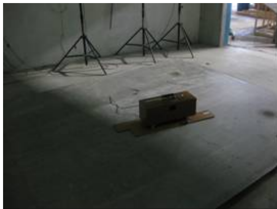
圖 24 建築總合試驗所—高頻樓板衝擊音實驗裝置
