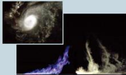
「旋風」の実験。横風中の火災風下に発生した旋風が、床面上に流した白煙で可視化されている。 Whirlwind experiment. Whirlwinds occurring downwind from a flame during a crosswind are made visible using white smoke released on the floor.
