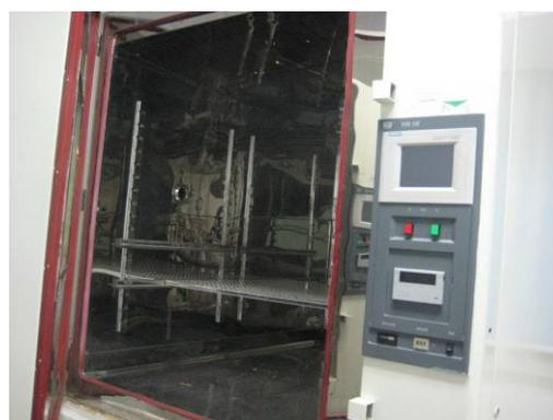
圖 27 冷熱衝擊試驗機(可外接監測系統)
