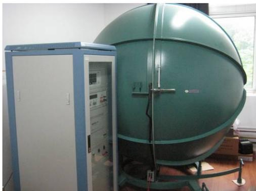
圖 4 全光束積分球實驗設備
