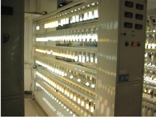
圖 30 光源光束維持率試驗機
