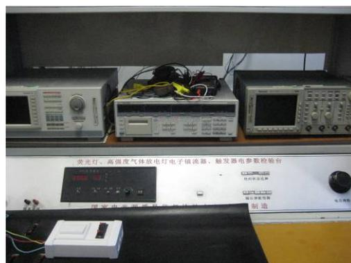
圖 29 氣體放電燈電性參數檢驗台
