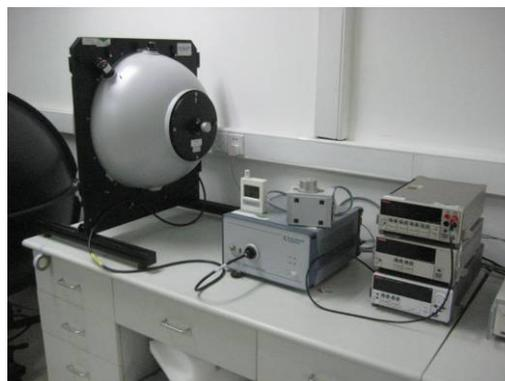
圖 23 量測 LED 元件特性積分球
