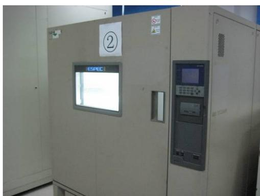
圖 26 冷熱衝擊試驗機 (-40~150°C)
