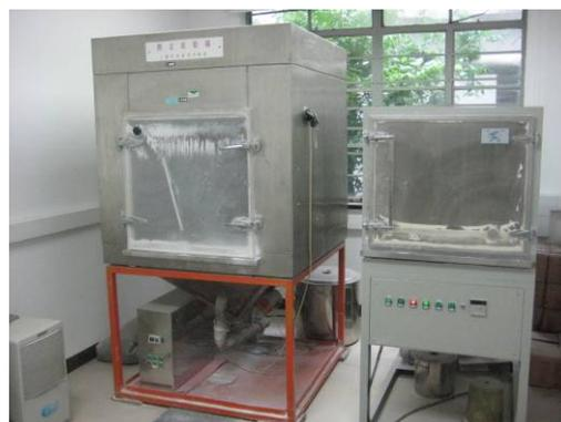
圖 25 防(耐)塵試驗機
