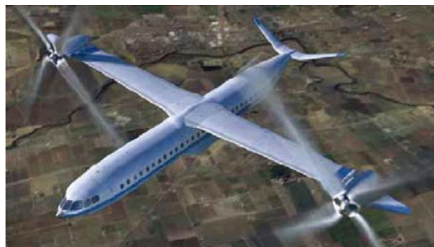
圖 13. 大型民用傾轉螺旋槳飛機之設計概念
