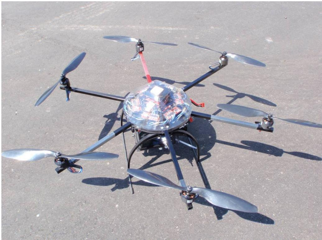
圖 4-17 自製簡易空照飛行器
