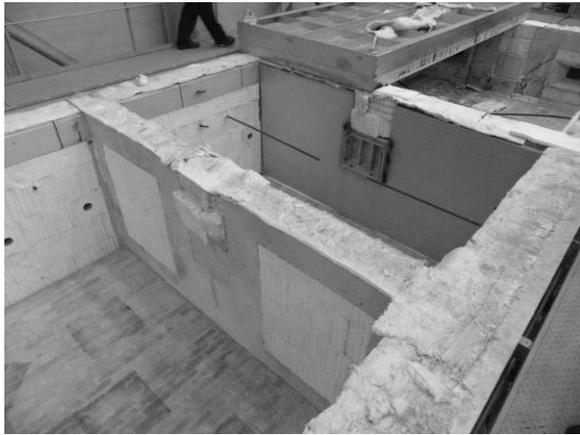
圖 8. 水平構件耐火實驗爐燃燒室及活動隔間
