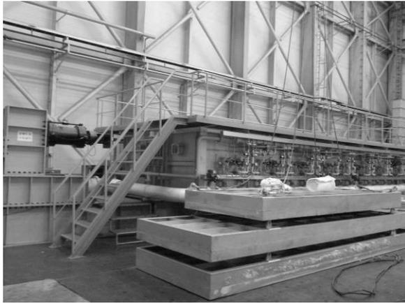
圖 7.水平構件耐火實驗爐
