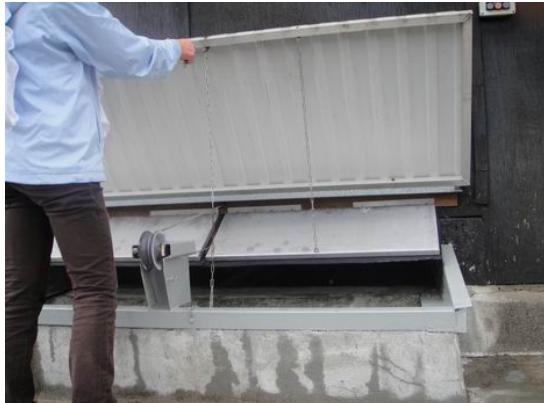
兔舍刮糞設備設有防鼠擋板
