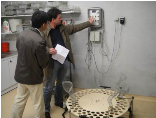
代謝試驗糞尿自動收集設備
