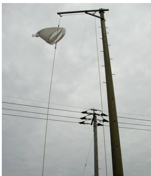
圖四十一、長距離遷移性害蟲偵測用之高空捕蟲網
