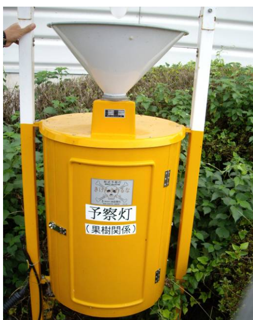
圖四十三、田間害蟲偵測調查用之誘蟲燈
