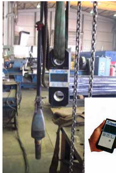
圖 36~38 S-,H-,F 公司 Premnitz 廠固定式起重機荷重試驗所用無線式電子荷重計, 右下圖摘自原製造廠網頁
