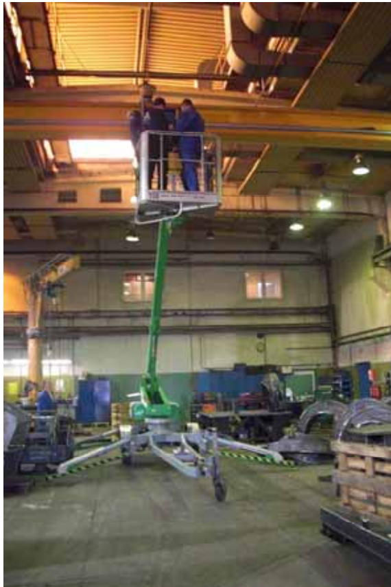
圖 43~47 固定式起重機檢查,運用電動高空工作車
