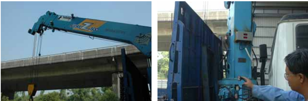
圖 4~5 勞研所技術移轉之過負荷預防裝置,高雄聯合電訊公司
