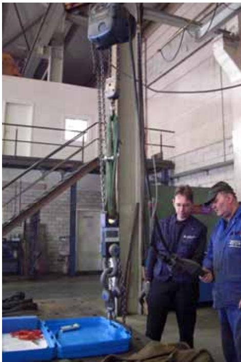
圖 36~38 S-,H-,F 公司 Premnitz 廠固定式起重機荷重試驗所用無線式電子荷重計, 右下圖摘自原製造廠網頁
