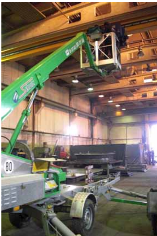
圖 43~47 固定式起重機檢查,運用電動高空工作車
