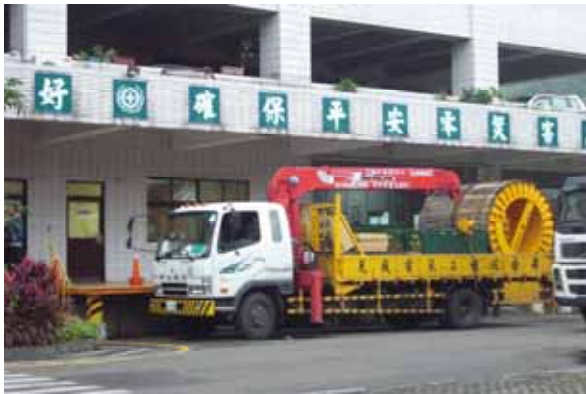
圖 12,13 積載型起重機,上為直臂式,下為曲臂式,黑色吊桿為瑞典 Hiab 廠,紅色吊桿為奧地利 Palfinger 廠,攝於北市區營業處 (95/0107,#13&10)
