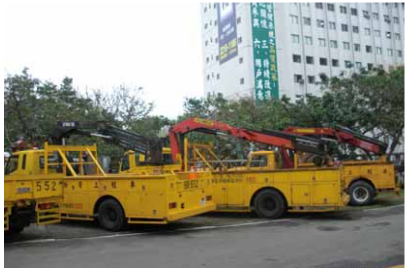
圖 12,13 積載型起重機,上為直臂式,下為曲臂式,黑色吊桿為瑞典 Hiab 廠,紅色吊桿為奧地利 Palfinger 廠,攝於北市區營業處 (95/0107,#13&10)
