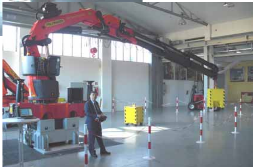
圖 14~15 Palfinger 位於 Salzburg 總部室內測試場有多座不同型號積載型起重機模擬器可供測試及訓練用 (98/1120,#CIMG1374,1569)
