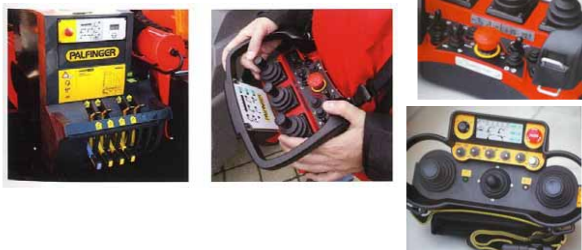
圖 18~21 Paltronic 電子式過負荷預防裝置,左為機載型,直接安裝於車上,右為無線遙控型
