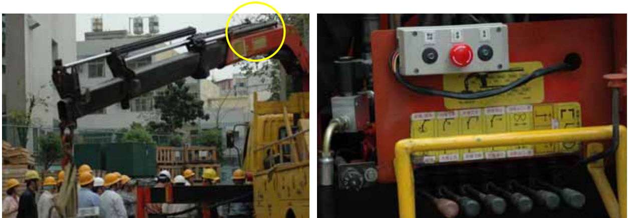
圖 1~2 台南區處公開測試裝有國產過負荷預防裝置之積載型起重機
