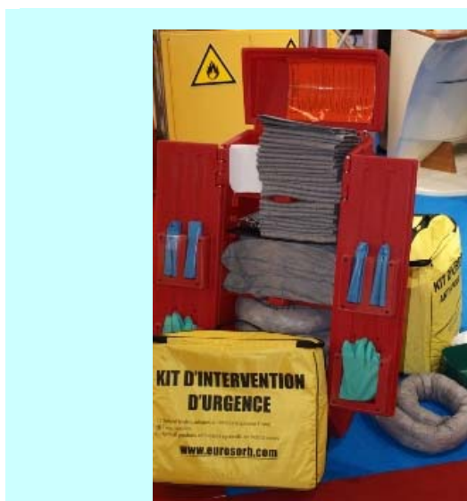
圖七、現場使用之除油及工安緊急應變設備
