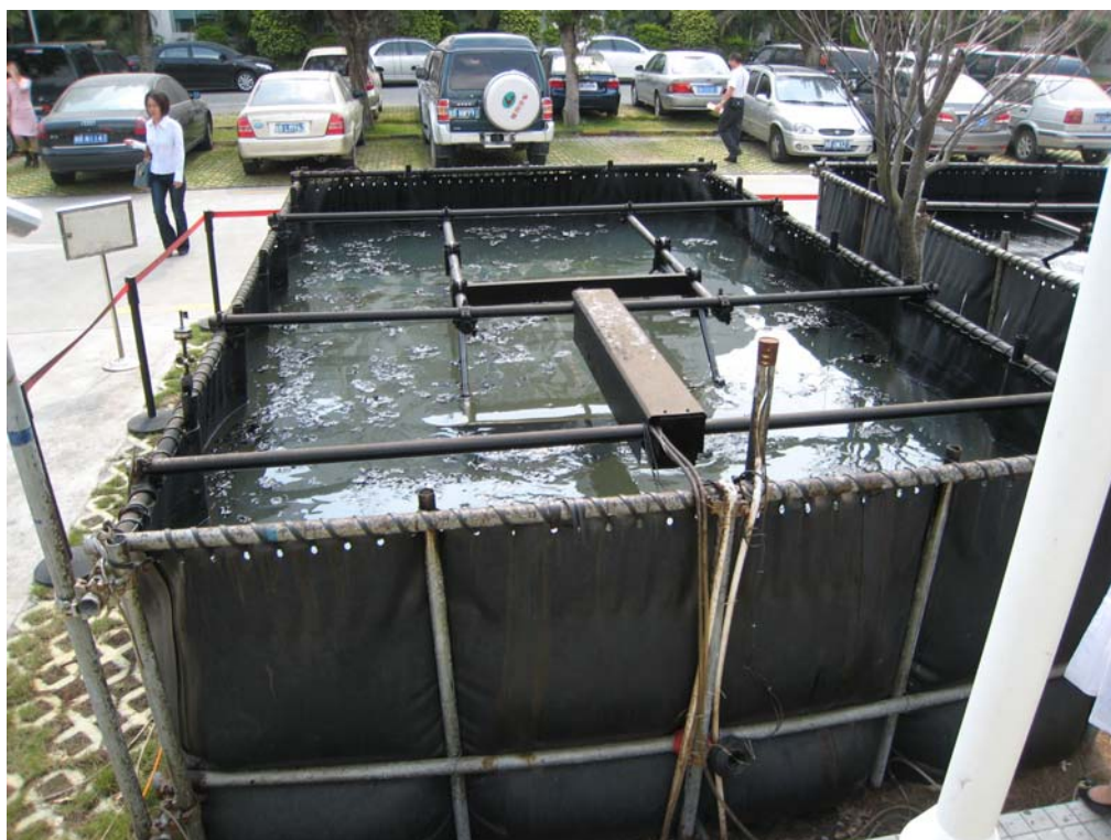
海上溢油風化模擬實驗裝置
