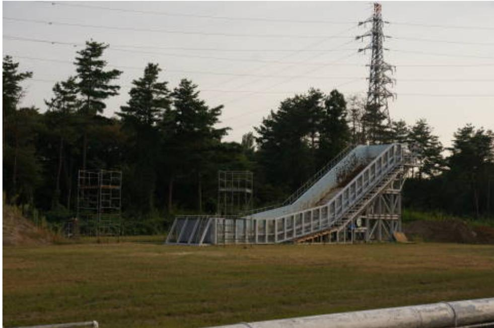
照片 3-2 淺層邊坡破壞模型支架
