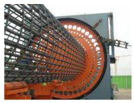
圖 2.7 鋼筋綁紮機具
