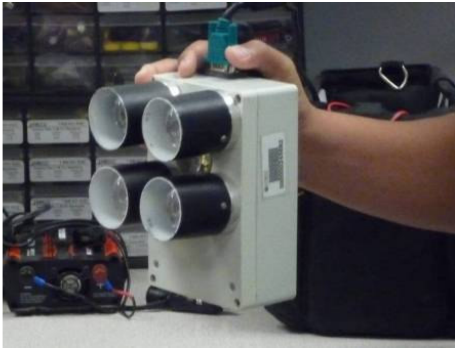
圖4-20 利用微波偵測HLB的病害
