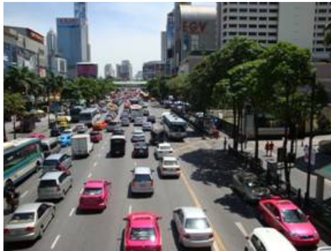
圖 46. 市區多採不平衡車道配置方式
