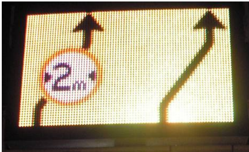
圖 16. 資訊顯示系統整合式應用(全彩顯示施工)-紐西蘭 (資料來源：本照片翻拍於 TELEGRA 公司展示資料)
