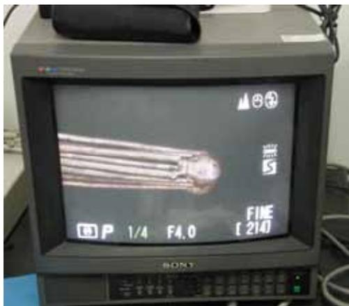
圖 25 ↑ 以實體顯微鏡觀察短路熔珠
