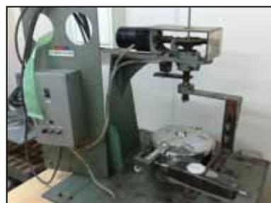
圖 13 ↑ 壓力鍋測試機
