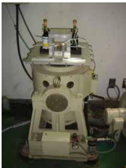
圖 48 ↑ 振動試驗機
