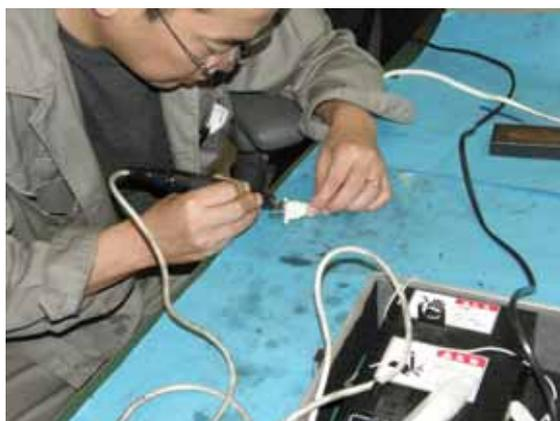
圖 20 ↑ 以超音波刀切割樣品
