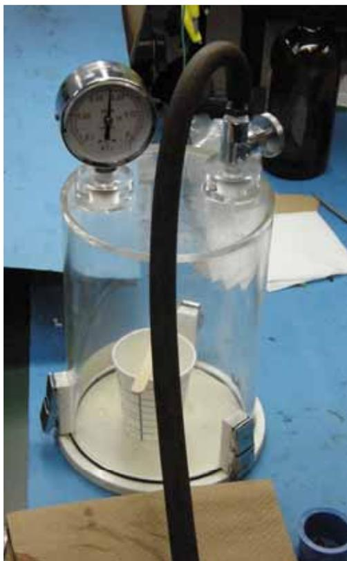
圖 27 ↑ 以真空罐製作鑲埋錠
