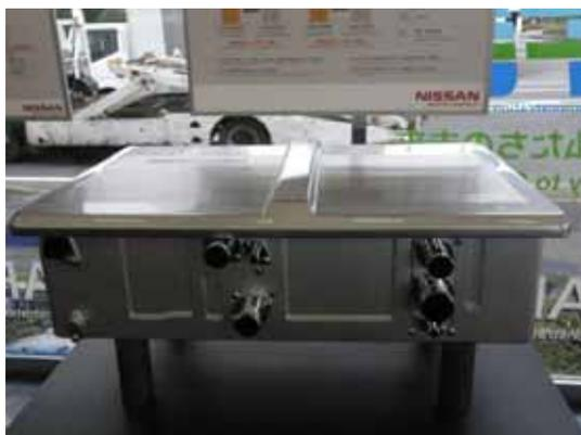
圖 55 ↑ NISSAN 車廠氫能燃料電池反應裝置
